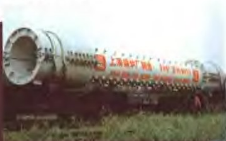
上海锅炉厂制造的 1025 吨/时锅炉汽包整装待运
