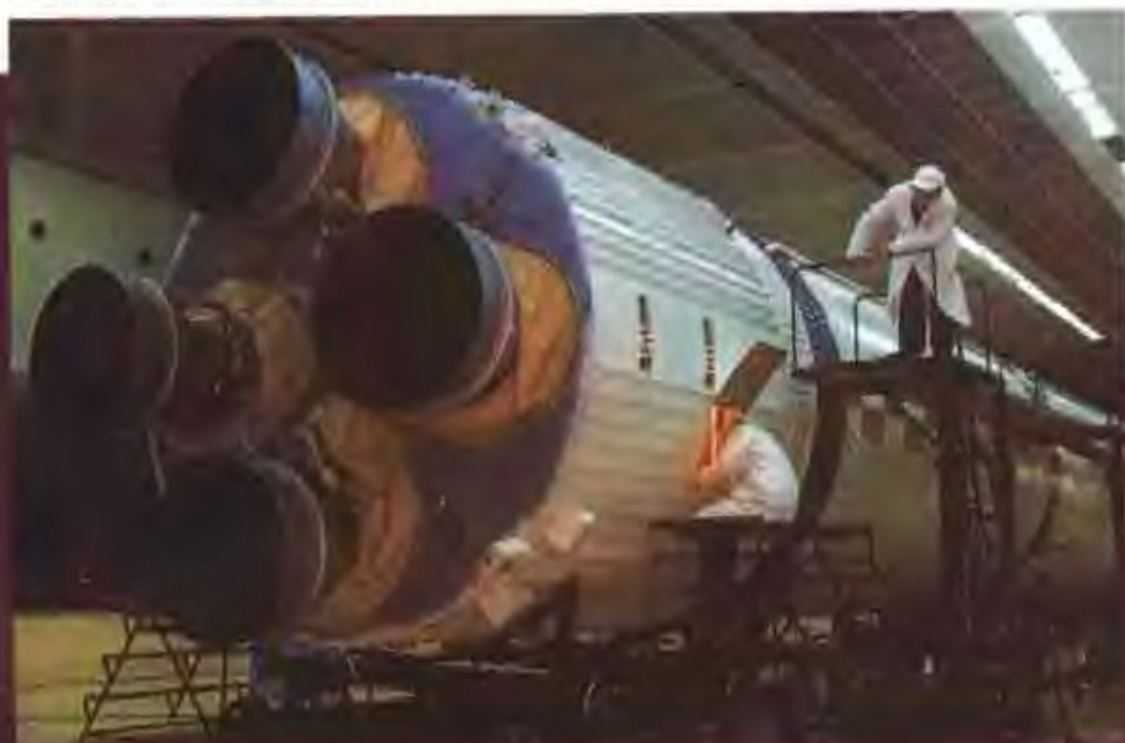
上海新中华机器厂科技人员测试长征四号(A)运载火箭
