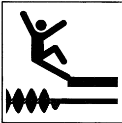
A4.2 跌落到机器螺旋输送机中
