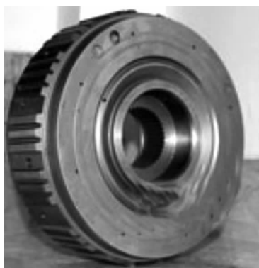
图 1—10 导轮包含一个单向滚柱离合器。离合器可以在某一个旋转方向锁定它，在相反的方向则允许它可以自由旋转
