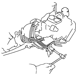
图 1-17 拆下 1 号空气管
