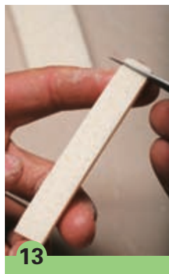
13 将两端切平并与底板粘接。
