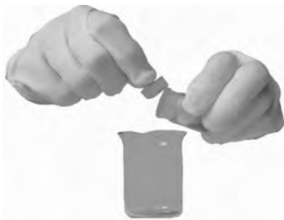
图 1-7 倒出药品的操作
