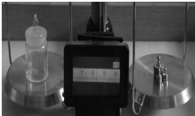
图 1-5 分析天平平衡状态
