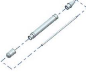
光盘范例65 圆珠笔产品爆炸图构建 语音视频学习文件\DVD2\CH07\圆珠笔产品爆炸图构建.avi
