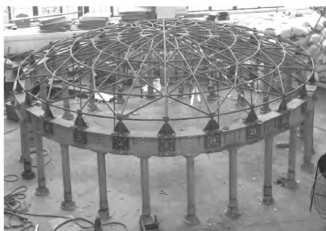
图 21 索穹顶—网壳结构试验模型
