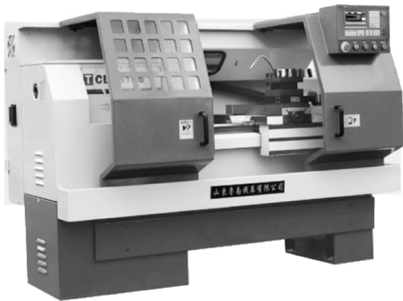
图 1-1 数控车床 CK6136 外形
