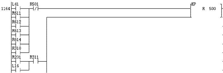
图 5-18 电梯轿厢上行趋势判断梯形图程序
