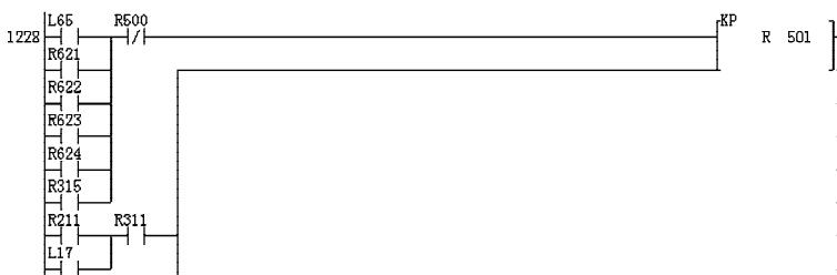
图 5-20 电梯轿厢下行趋势判断梯形图程序
