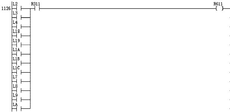
图 5-17 轿厢在 1 层时上行趋势判断梯形图程序
