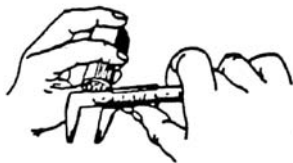
(d) 游标卡尺检测内径
