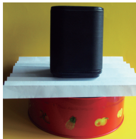
(e) 纸的刚度提高后能支承重物
