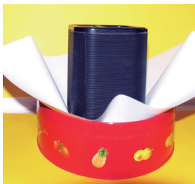
(c) 纸因变形不能支承重物
