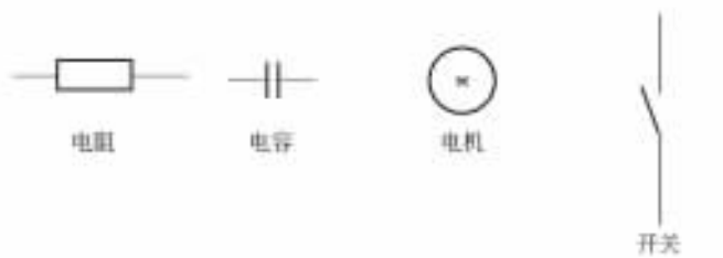
图 1-11 一般图形符号示例
