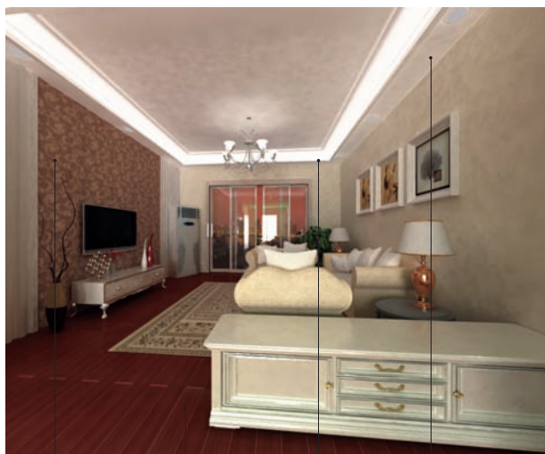
壁纸 实木地板 反光灯带 石膏板吊顶
