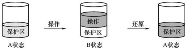
图 1-1 硬盘保护卡简单工作原理
