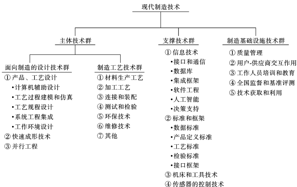
图 0-1 现代制造技术的体系结构
