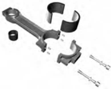
图 1.4 几个零件的刚性组合而形成一构件
