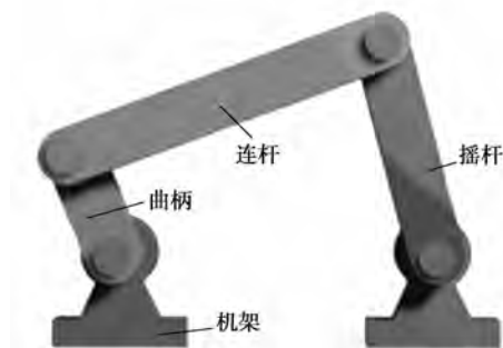
图 1.13 铰链四杆机构的组成
