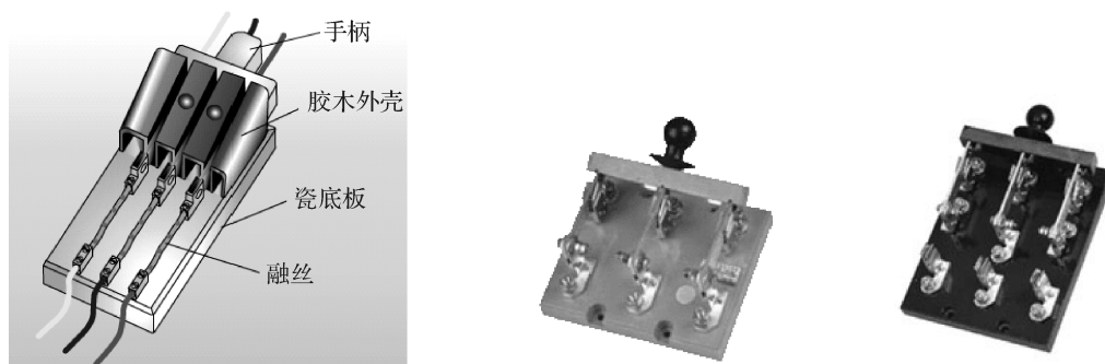
图 1-6 刀开关典型结构及外形图
