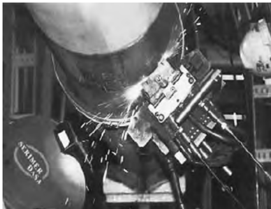
图 1.2 Saturnax Bug 双焊炬管道全位置自动焊机
