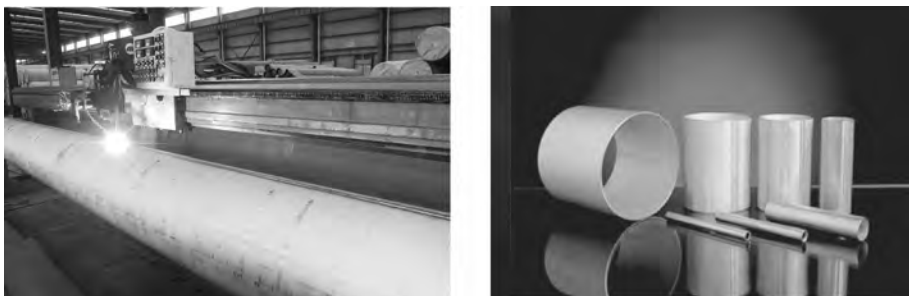
图 1.3 焊接管生产线及样品
