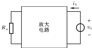
图 1.2 放大电路的输出电阻定义
