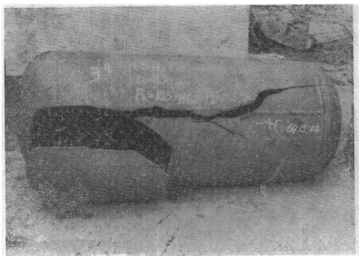
图 I-9 3*容器 (-40°C) 低温爆破后之破裂照片。
