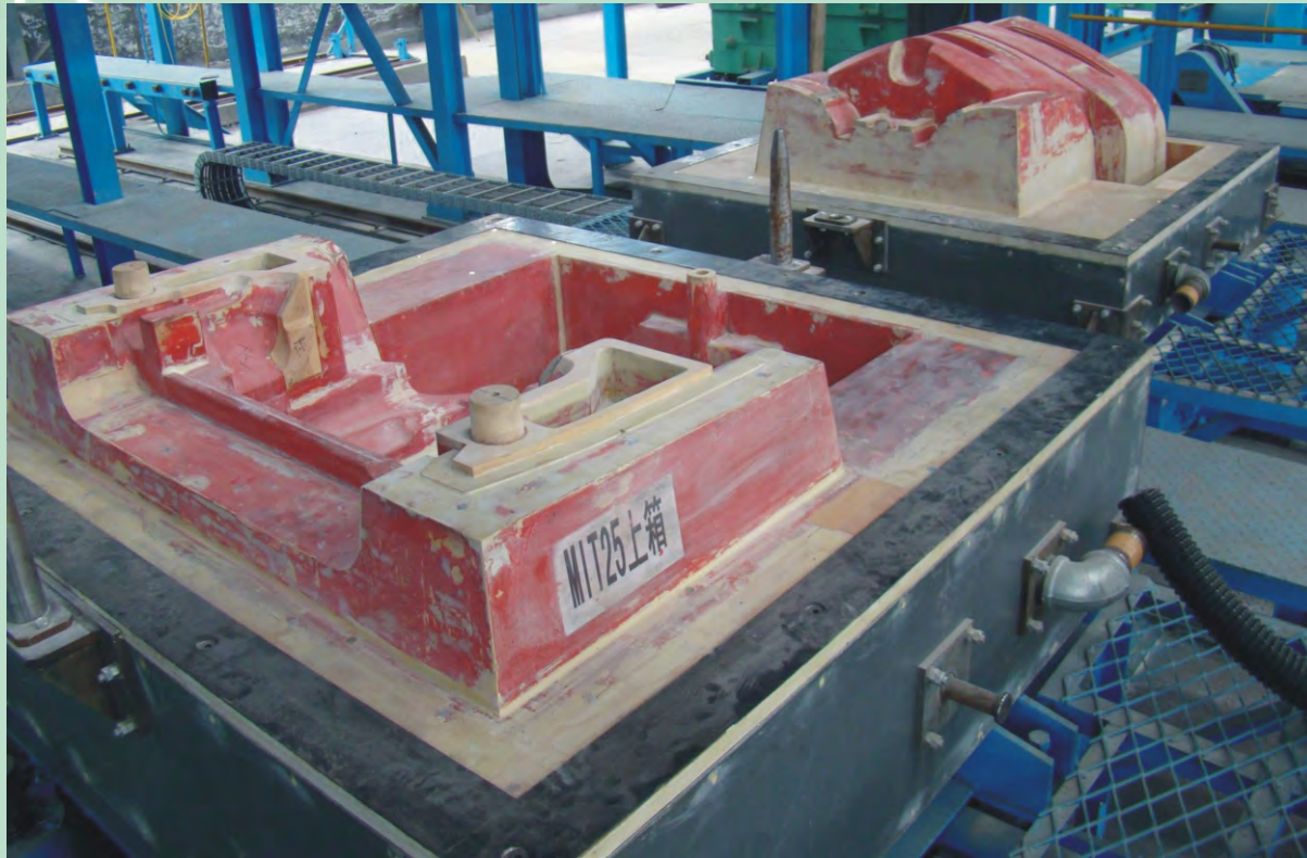
V法铸造铸铁配重平衡块用上型和下型的模具。
