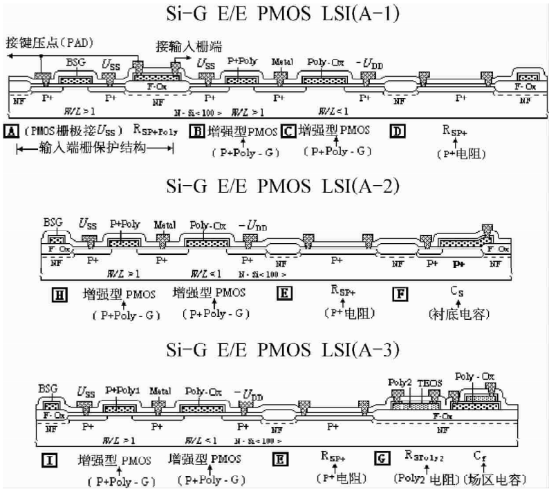
图 1-4 硅栅 E/E 型 PMOS IC 芯片典型剖面结构示意图
