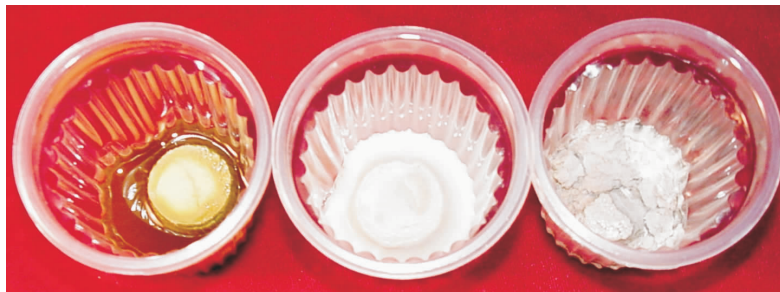
图 3-3 简单的页岩浸泡实验 左→右, LG 植物胶→普通膨润土钻井液→清水
