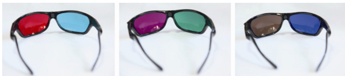
彩图 5-2 观看分色立体影像的红蓝立体眼镜、红绿立体眼镜和棕蓝立体眼镜
