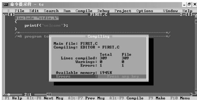
图 1-9 编译出现错误后的 Compiling 窗口
