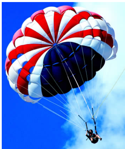
当降落伞下落时,空气在伞下聚集,使降落伞的下落减慢,形成了软着陆。
