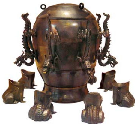
Прибор Хуэфэньи. Чжан Хэн (78 – 139 г.) изобрел первый в мире чувствительный сейсмограф, показывавший направление на эпицентр землетрясения.
