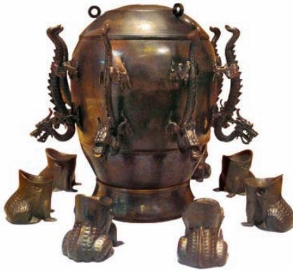
مرسمة فنغهو للزلازل، هي أول مرسمة لزلازل لتحديد جهة الزلازل في العالم، مخترتها تشانغ هنغ (٧٨-١٣٩).
