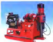
XY-2B 型岩芯钻机
