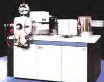
Finnigan Triton 热电离质谱仪
