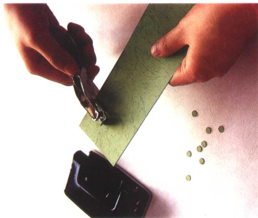
用打孔器打出所需的圆孔或小圆片
