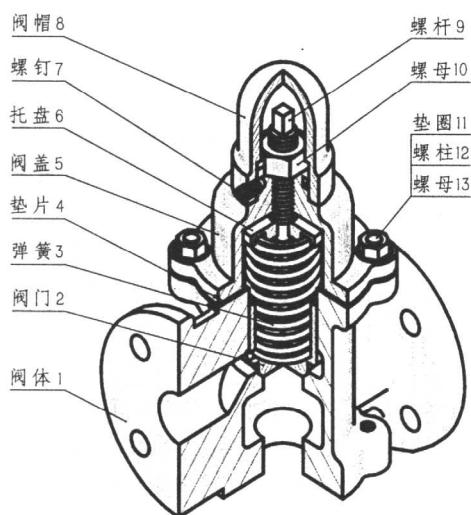
图 1.3 安全阀轴测剖视图
