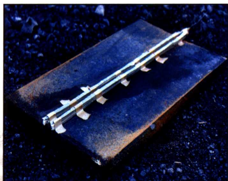
焊接试板的爆炸处理照片
