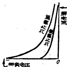
图 1-2 电子管的屏流—栅压曲线
