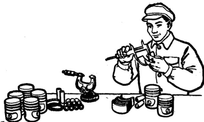
的精密量具，除了游标卡尺、螺旋測微器外，还有千分表以及利用光学原理的光学比較仪、工具显微鏡等。
