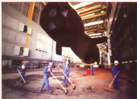
彩图4 法国“凯旋”级核潜艇采用泵喷射式推进器，舰部结构为“H”形
