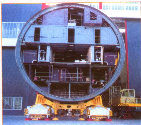
彩图9 主段装配，图中舱段内已经安装了部分设备、管路和压载铁等
