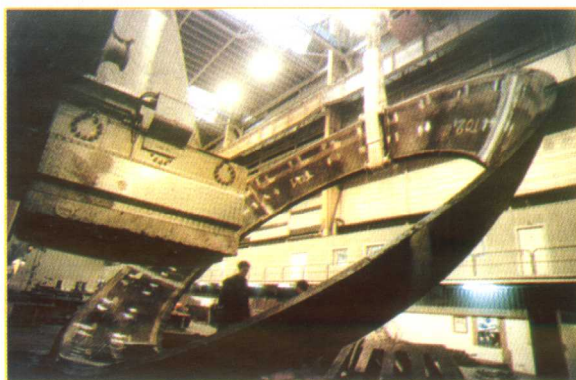
彩图8 分段装配,由8块弧形耐压壳 焊接的小段锥形耐压壳圈
