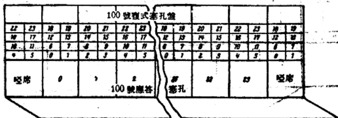
圖 15 容量為2400號磁石式話局其複式塞孔採用6塊面板制時，100號應答及複式塞孔盤的佈置
