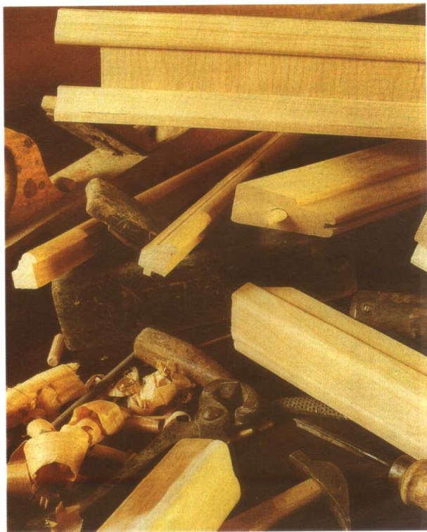
图18 燕尾榫结构的抽屉及装有圆榫的家具部件
