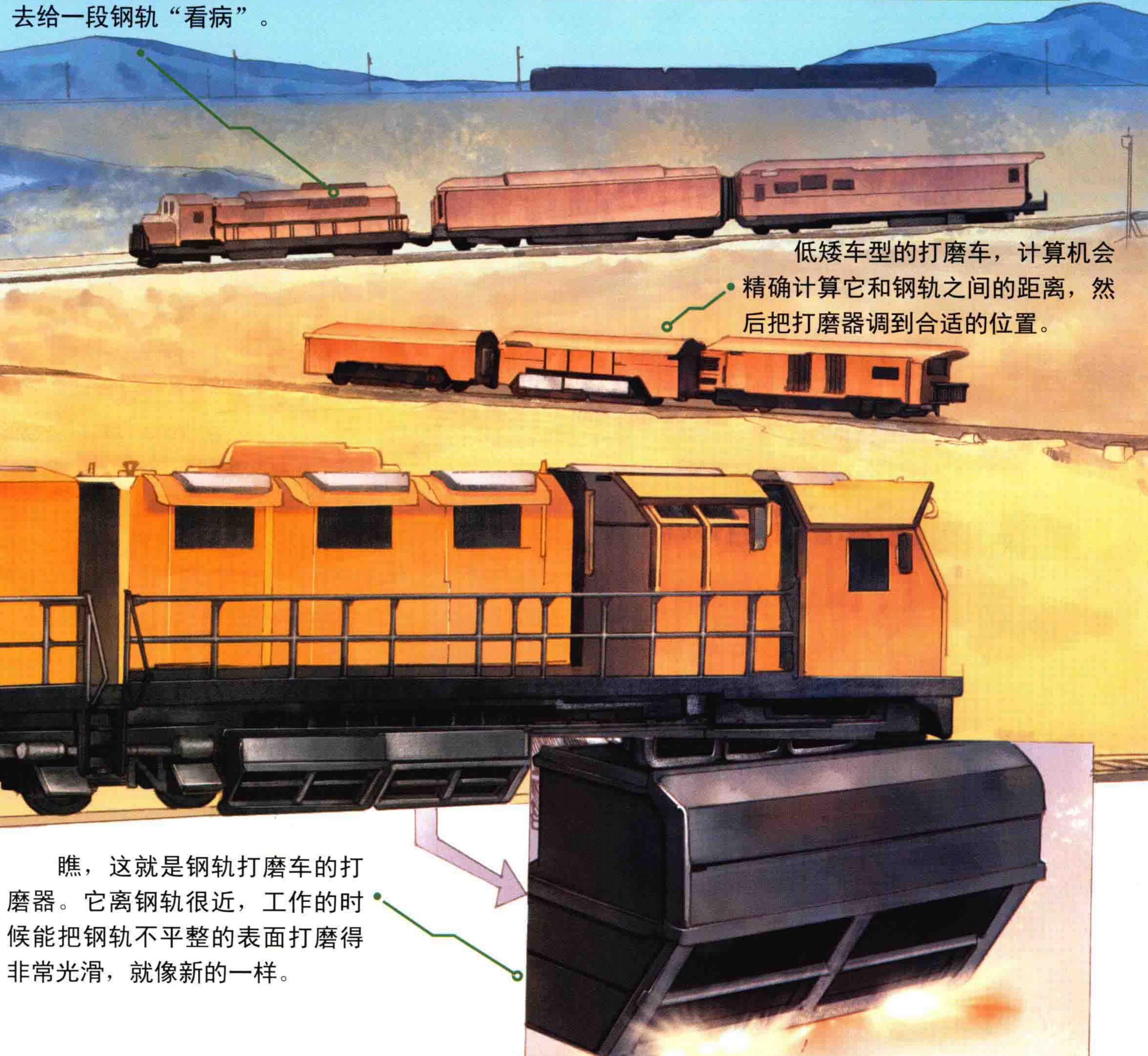
瞧，这就是钢轨打磨车的打磨器。它离钢轨很近，工作的时候能把钢轨不平整的表面打磨得非常光滑，就像新的一样。
