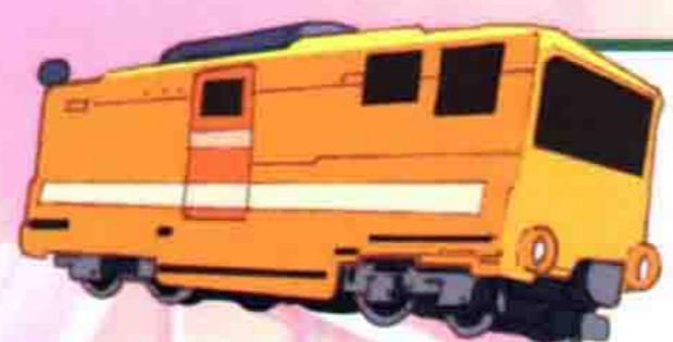
钢轨如果使用的次数太多了，也会“生病”——出现裂璺(wèn)，有时还会因此引发事故。1928年10月，美国第一辆钢轨探伤车投入使用，给钢轨“体检”。按探伤检测原理可以将探伤车分为电磁钢轨探伤车和超声波钢轨探伤车两类。
