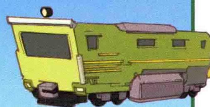
低矮车型的打磨车，计算机会精确计算它和钢轨之间的距离，然后把打磨器调到合适的位置。
