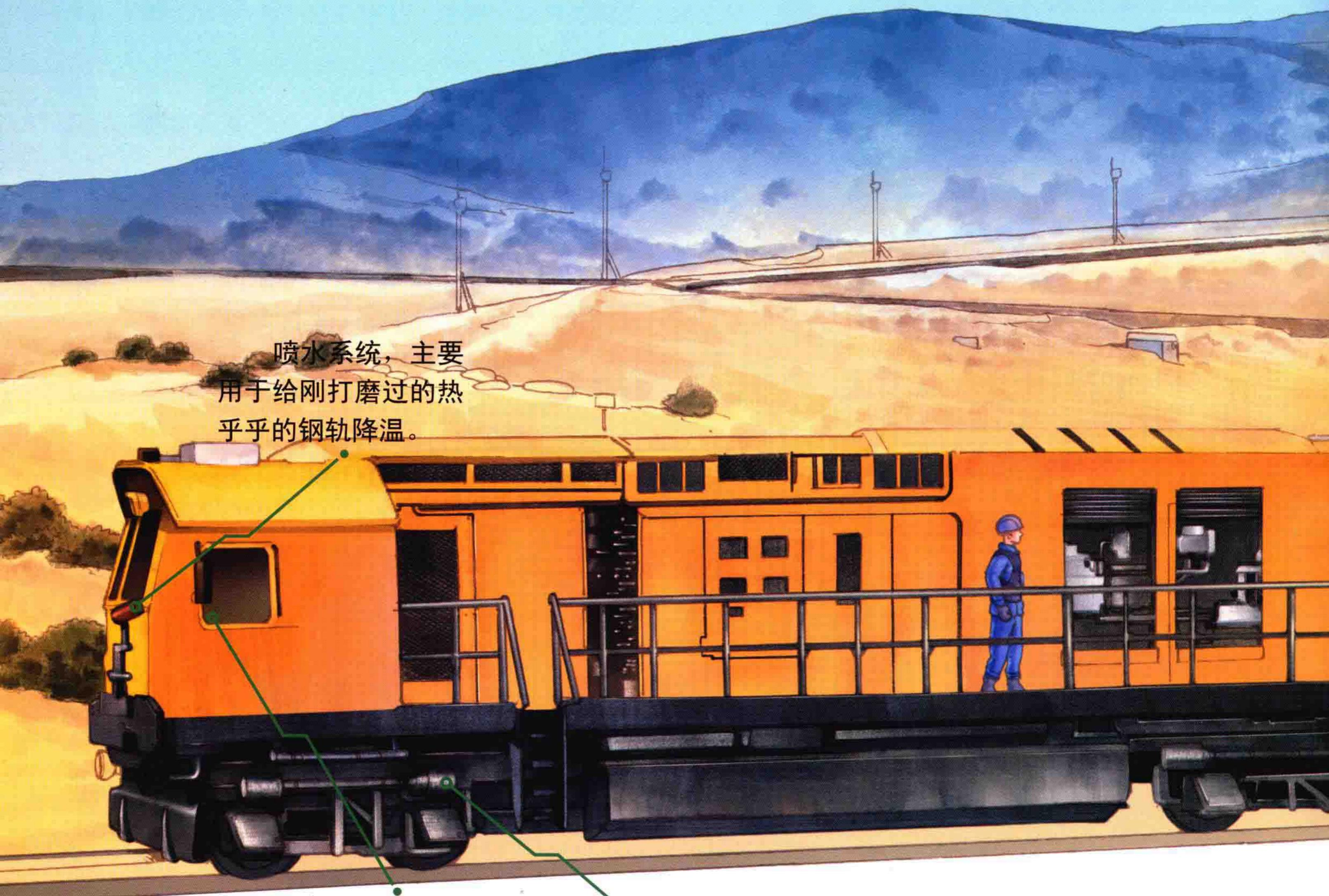
喷水系统，主要用于给刚打磨过的热乎乎的钢轨降温。
