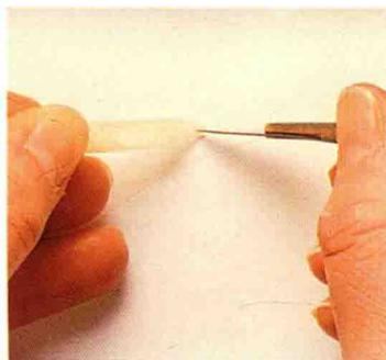
3. 贯穿笔尖，切出较短的一段纵向切口，使得笔尖能获得墨水的补充。移去羽管内外的杂物和碎屑。
