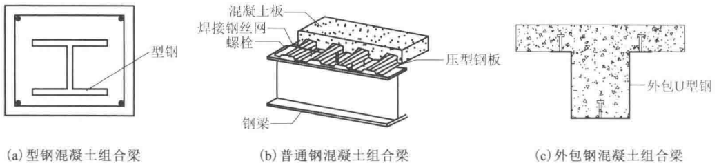
图 1.1 钢-混凝土组合梁示意图
