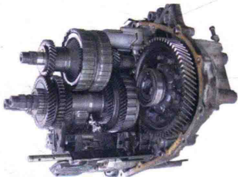
图 1-4 本田 5AT 平行轴式自动变速器
