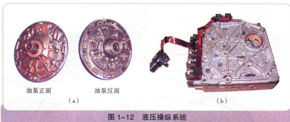
(a) 油泵；(b) 阀体（包括电磁阀及液压管路）
