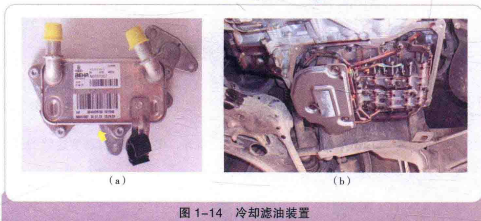
(a) 冷却装置；(b) 滤油装置
