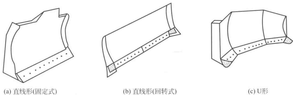
图 1.8 推土铲横向结构
