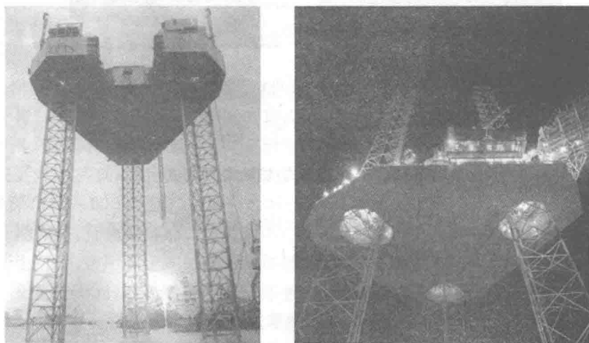
图 1-13 槽口:有槽口;无槽口
