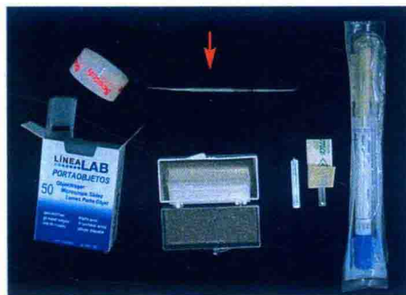
图 1-2 收集标本的材料。箭头指示 Le Cron 刀
