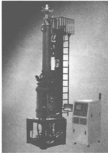
图 1-5 税目 84.86 的半导体单晶炉
