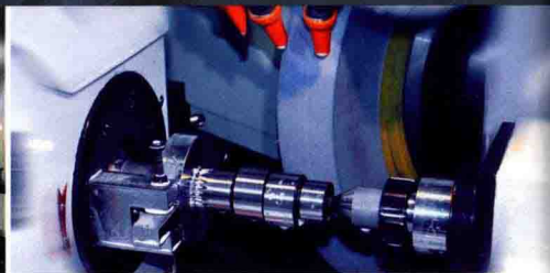
H367数控机器人RV减速器偏心轴专用磨床
