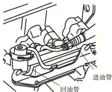
图 1-1-9 拆下进油管 and 回油管
