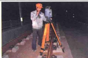
3. 校准 GEODE 小车。通过蓝牙将轨道小车和手簿连接,打开手簿“结构”菜单第一项“校准”菜单,依次对超高、轨距进行调整
