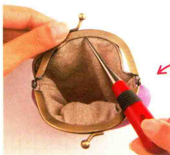
2. 将袋口与口金的中心点对齐后，用锥子将袋边塞入口金中。要确认一下袋子边上的位置是否与铆钉的位置一致。
